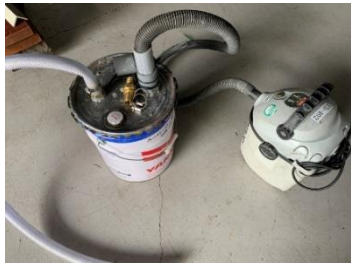
廃棄ペール缶を再利用した汚水ポンプ
